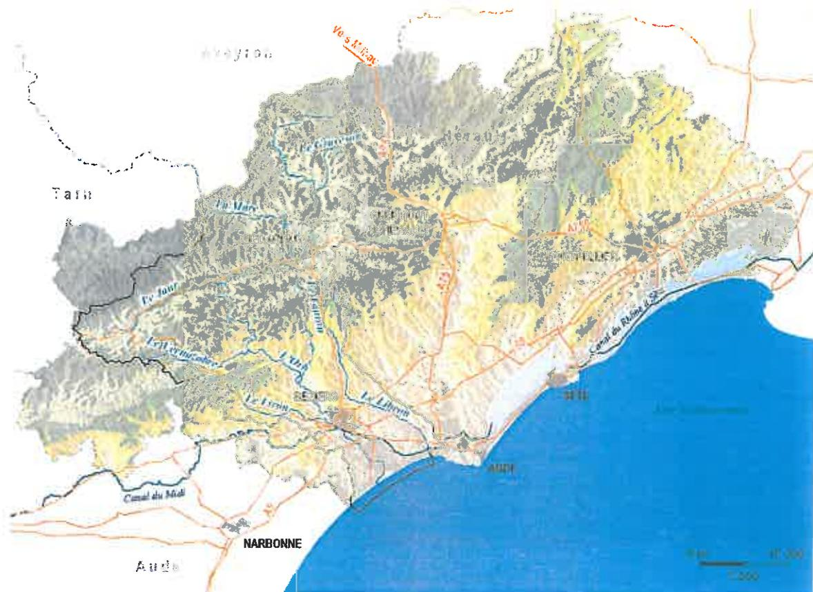
Un fort gradient de précipitations s'observe entre la plaine littorale - 600 mm - et les reliefs les plus élevés, où la pluviométrie annuelle atteint 1500 mm. Ces caractéristiques climatiques se traduisent sur le plan hydrologique par des épisodes d'étiage sévère et des épisodes de crues torrentielles. Outre le Jaur, les affluents les plus importants de l'Orb sont la Mare, le Vernazobres et le Libron en rive droite, le Gravezon et le Taurou en rive gauche.
