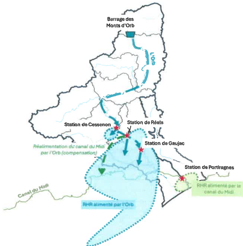
Figure 5. Utilisation de l'eau du barrage des Monts d'Orb
