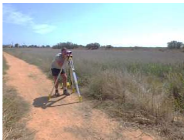
Pose de repères altimétriques à partir du réseau national de IGN.
