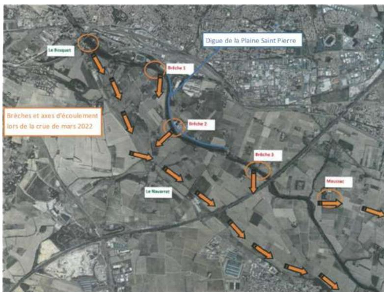
Face à la digue de la Plaine St-Pierre, en rive droite de l'Orb, des merlons agricoles ont cédés lors de la crue de mars 2022 (supérieure à une crue décennale), inondant des vignes et domaines isolés, y provoquant certains dégâts. Cet épisode de crue a mis en évidence l'intérêt de mobiliser les zones d'expansion de crue, sur cette rive droite (permettant ainsi d'éviter des impacts sur la digue de la Plaine St-Pierre) mais rend nécessaire le fait d'organiser cette expansion afin qu'elle ne
