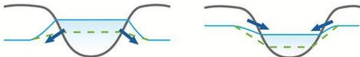
**Figure 1 : Exemples de relations possibles entre un cours d'eau et sa nappe d'accompagnement (A gauche : alimentation de la nappe par le cours d'eau, A droite : alimentation du cours d'eau par la nappe)**
